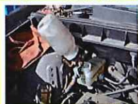
ブレーキオイル交換
